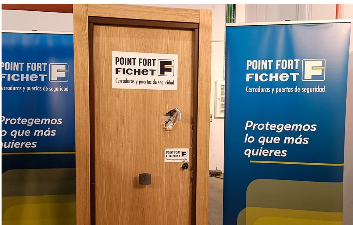
En un ambiente distendido y muy didáctico **técnicos y expertos de Point Fort Fichet realizaron un impactante test de resistencia a dos puertas** instaladas para la ocasión delante de los medios de comunicación. Todos fueron testigos de cómo un técnico conseguía abrir una puerta blindada en menos de un minuto con una rotura de cilindro y posteriormente mediante apalancamiento; mientras **la puerta de Point Fort Fichet resultaba infranqueable** ante dichos ataques.
